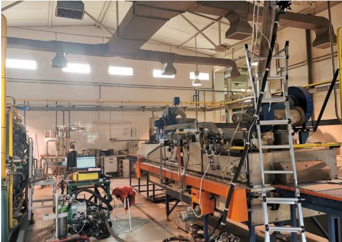
Figura 6. Horno continuo de combustión a escala piloto
